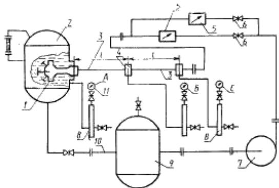
1—испытуемое изделие; 2—основной бак; 3—мерный участок трубопровода; 4—уравнительная камера; 5—разделомер; 6—задвижка; 7—центробежный насос; 8—демпферное устройство; 9—канализационный бак; 10—трубопровод; 11—манометр.
