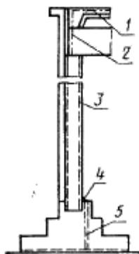
1 — молниезащитная сетка; 2 — токоотвод; 3 — арматура колонны; 4 — заземляющая перемычка; 5 — арматура фундамента
