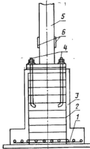
1 — арматура подошвы; 2 — арматура фундамента; 3 — фундамент; 4 — фундаментные болты (не менее двух), соединенные с арматурой фундамента; 5 — стальная колонна; 6 — пластины для приварки проводников заземления
