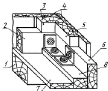
1 — полоз; 2 — продольный брус бокового щита; 3 — стойка угловая бокового щита; 4 — доска обшивки; 5 — стойка угловая; 6 — продольный брус торцовочного щита; 7 — доска дна; 8 — торцовый брус
