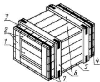
1 — доска торцового щита; 2 — планки торцовых щитов; 3 — доска крышки; 4 — доска бокового щита; 5 — доска dna; 6 — планки поясов; 7 — металлическая лента
