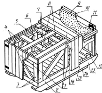
1 — доски обшивки; 2 — продольный брус; 3 — угловые стойки; 4 — раскосы; 5 — промежуточная стойка; 6 — опорная планка; 7 — продольные брусы крышки; 8 — поперечные брусы крышки; 9 — водонепроницаемый материал; 10 — планка; 11 — металлический уголник; 12 — торцовый брус; 13 — полоз; 14 — подполозная доска; 15 — крепежный брус; 16 — доска dna
