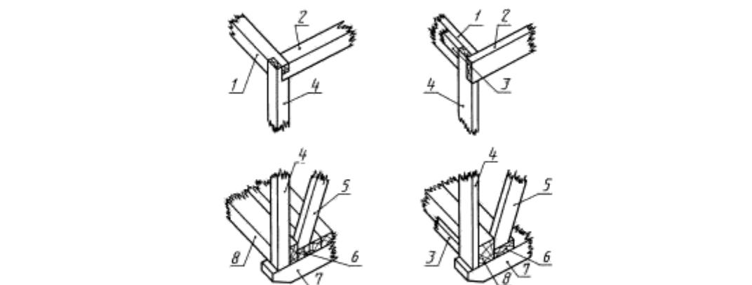
1 — продольный брус торцового щита; 2 — продольный брус бокового щита; 3 — вкладыш; 4 — угловая стойка;
