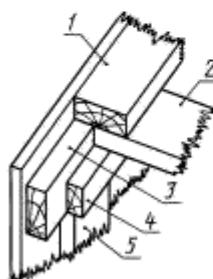
1 — продольный брус крышки; 2 — поперечный брус крышки; 3 — продольный брус бокового щита; 4 — опорная планка; 5 — стойка
